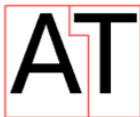
Рис. 2. Схема кернинга в металлическом шрифте
