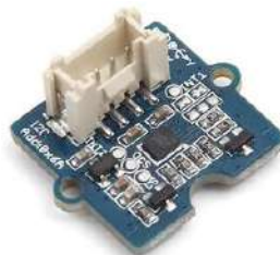
Рисунок 2.2 – Модуль Grove – 6-Axis, на основе акселерометра «LSM6DS3»
