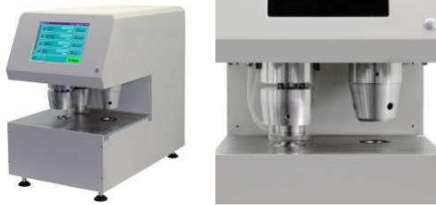
Рисунок 3.12 – Прибор для измерения воздухопроницаемости и шероховатости по Бендтсену
