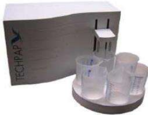
Рисунок 3.1 – Анализатор волокна Morfi Compact
