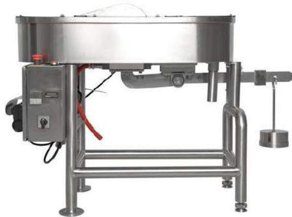
Рисунок 3.5 – Лабораторный ролл Валлея
