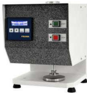
Рисунок 3.8 – Универсальный толщиномер со сменной измерительной площадкой
