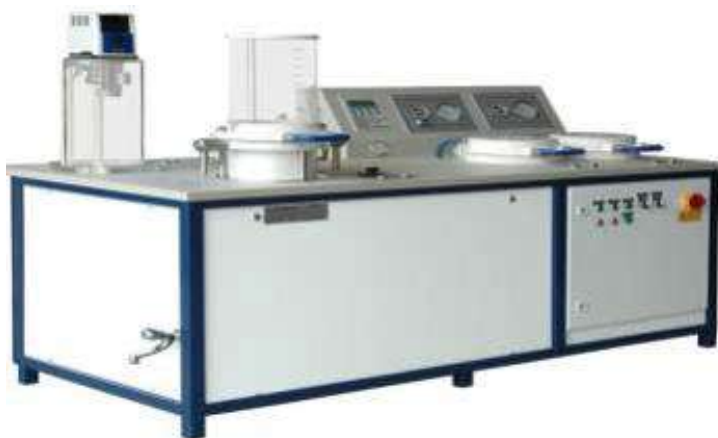
Рисунок 3.7 – Листоотливной аппарат Рапид-Кетен с автоматическим управлением
