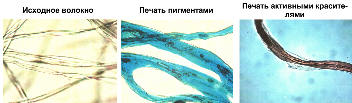
Рисунок 7 – Микрофотографии целлюлозного волокна до и после процесса печати.
