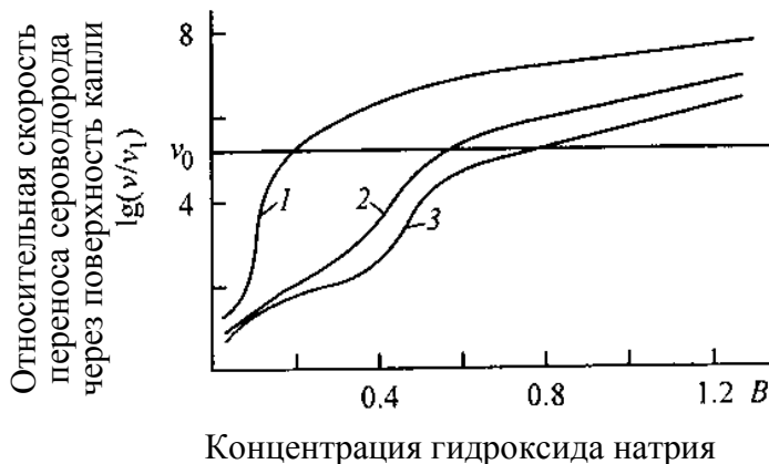
Рис. 15 Зависимость относительной скорости переноса сероводорода \lg(v/v_1) через межфазную границу в газовой фазе от концентрации исходного раствора гидроксида натрия B (моль·л -1 ) при разном времени абсорбции \tau . T=21^\circ\text{C} , D=1.71 \cdot 10^{-9} м 2 ·с -1 , R=3 \cdot 10^{-4} м, v_1=10^{-3} м·с -1
