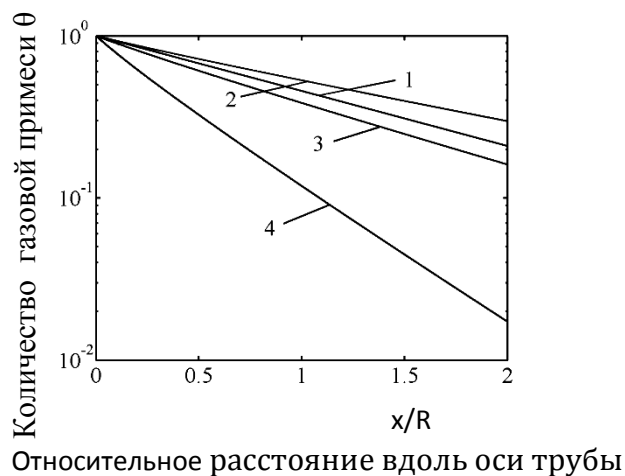
Рис.20 Зависимость количества газовой примеси \theta от расстояния вдоль оси трубы для равномерного распределения плотности орошения (1) и неравномерного распределения (2,3,4) с разными коэффициентами диффузии D ( \text{м}^2/\text{с} ): 2 - 2 \cdot 10^{-5} , 3 - 10^{-3} , 4 - 5 \cdot 10^{-3}
