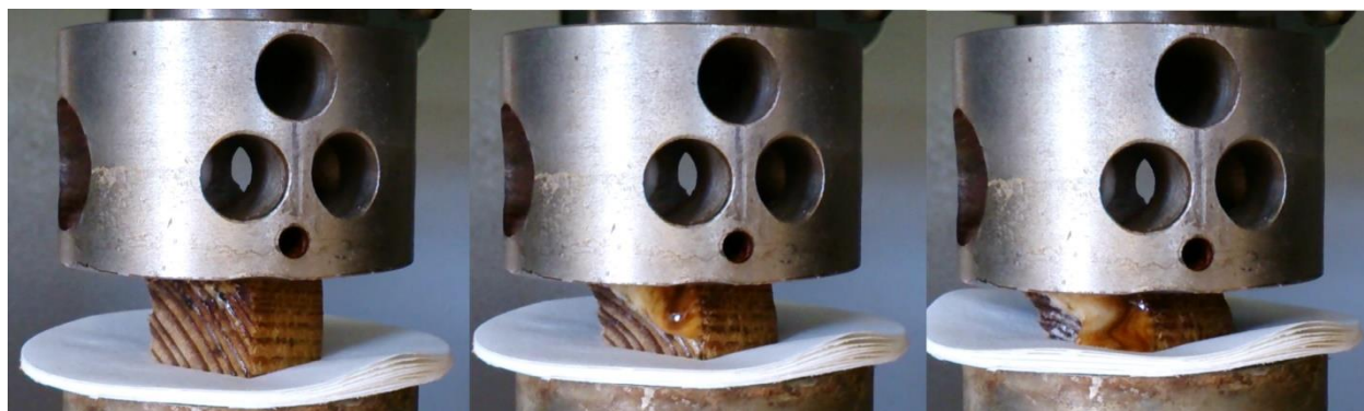
Рисунок 3 - Выделение жидкости при сжатии кубика древесины лиственницы
