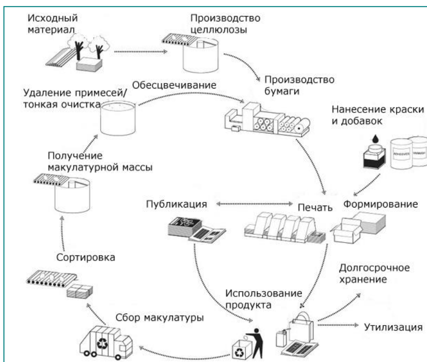
Рисунок 2 – Схема процесса переработки макулатуры
