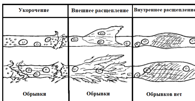
Рисунок 1 - Действие ножей на волокна в процессе размола
