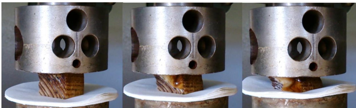
Рисунок 1 – Выделение жидкости при сжатии кубика древесины лиственницы
